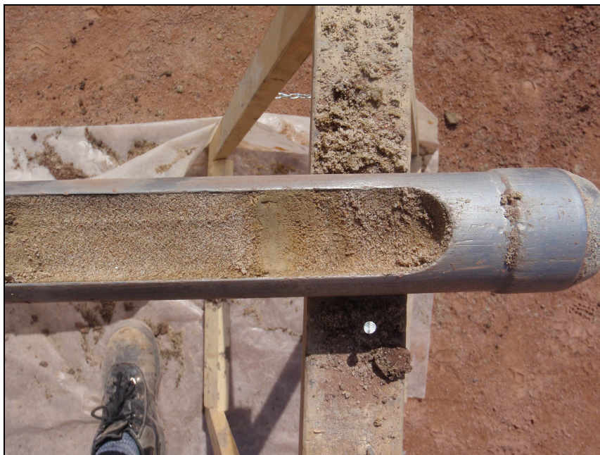
Bild 2: Im Liegenden der wasserstauenden Auffüllungen stehen fein- bis mittelsandige Quartärsedimente mit geringfügigen Feinkornanteilen an. Aus feinstratigraphischer Sicht alternieren in den Profilen bis ca. 7 \text{ m} u. GOK hochprozentige Sande und untergeordnet geringmächtige, leicht schluffige Horizonte (Kornanteile \leq 0,063 \text{ mm} ) in einer Größenordnung von wenigen Zentimetern (Bild Mitte). Mit zunehmender Teufe war eine deutliche Abnahme des Feinkorns zu protokollieren.
