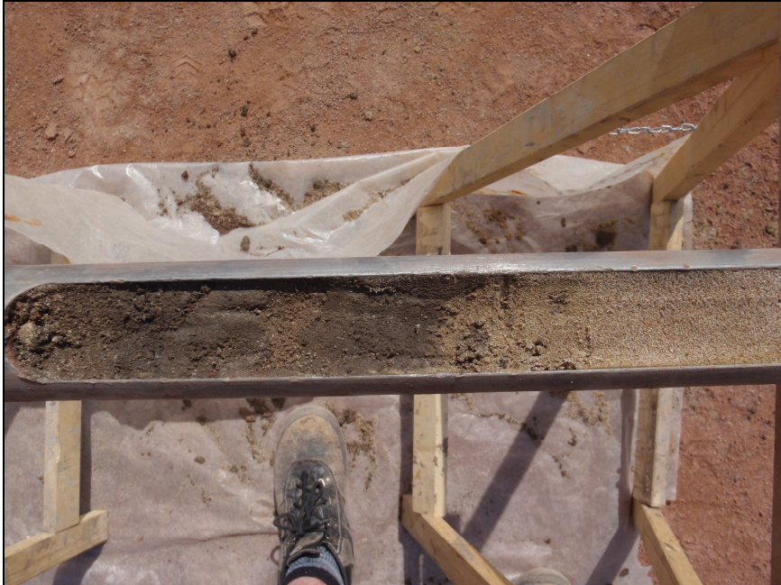
Bild 1: Bei Horizontstärken von \pm 0,8 m war in Tiefen von grob abgeschätzt ca. 1 \text{ m} \pm 0,2 \text{ m} u. GOK ein Übergang in Feinsande und Mittelsande mit geringfügigen Feinkornanteilen zu beobachten. In den Auffüllungen waren geringfügige Anteile von Fremdstoffen wie Bauschutt und Schlacken erkennbar. Die anthropogenen Bodenschichten waren durch wenig auffällige Farbwechsel von braun bis dunkelgrau gekennzeichnet.
