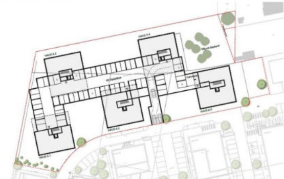
Baufeld A1_Häuser A.1-A.5_Tiefgarage_M 1:500
